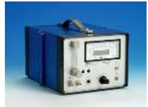
Ratfisch RS53-T, draagbare FID TOC-analyzer, met geïntegreerde gasflessen voor brandergas en kalibratiegas (1L, hervulbaar), automatische ontsteking, vlambewaking enz. gewicht ca. 20kg
