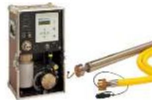
Gasmeter met vochtabsorptietrap in stevig draagrek voor manuele isokinetische regeling
