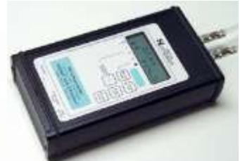
Digitale manometer Special instruments DIGIMA voor verschilindruck, meetbereik +/- 19,99 mbar (+/-1999Pa) of hoger. Mogelijk met analoge signaaluitgang 0-1V voor aansluiting op een datalogger. IP64
