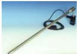
Verwarmde sonde Jumatherm met verwarmde filter, lengte 1m, andere lengtes op aanvraag
