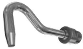
Schwanenhalsdüse für kleine Messöffnungen ( $G2 \approx 56,6\text{ mm}$ ), nach EN 13284-1 und ISO 9096, 8 und 10mm Durchmesser. Andere Durchmesser sind nicht nach EN 13284-1 und ISO 9096. Anschluss G1/2. Andere Gewinde auf Anfrage.
