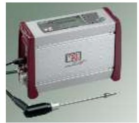
Horiba PG350 draagbare gasanalyser voor  $O_2$  (paramagnetisch), CO (NDIR),  $CO_2$  (NDIR),  $SO_2$  (NDIR),  $NO_x$  (chemiluminiscentie) met ingebouwde  $NO_x/NO$  convertor
