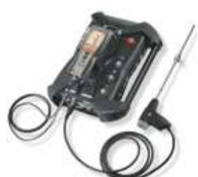
MRU Varioplus Industrial draagbare rookgasanalyser voor max. 9 parameters ( $O_2$ , CO, NO,  $NO_2$ ,  $H_2S$ ,  $H_2$  electrochemisch en CO,  $CO_2$ ,  $CH_4/C_3H_8$  met NDIR)
