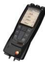
Testo 340 rookgasmeter voor industriële emissiemetingen, met zuurstofmeting en 3 optionele meetcellen
