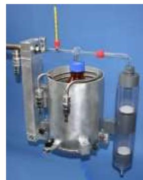
Verrerie avec trap d'adsorption pour prélèvement dioxines
