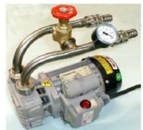
Membraanpomp KNF tot 55L/min met dubbele pompkop
