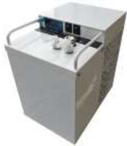
Circulatiekoeler Jumatec DLK1002 (39kg), circulatiepomp 13L/min, max. opvoerhoogte 27m, koelvermogen 980W bij 30°C omgevingstemperatuur
