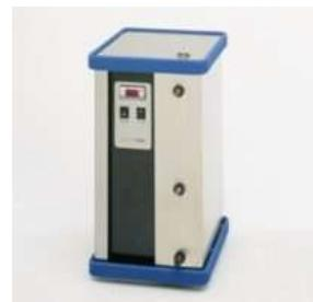
Immersiekoeler Jumatec TK501 (24kg), koelvermogen 520W, koelspiraal diameter 50mm lengte 120mm, met geïsoleerde slang en temperatuurregeling
